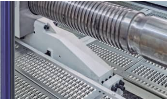
기계의 측면 및 베드의 고강성 가동형판 지지 장치와 가이드 메커니즘은 고중량 금형 장착 시 가동형판의 정밀도를 보장합니다.
