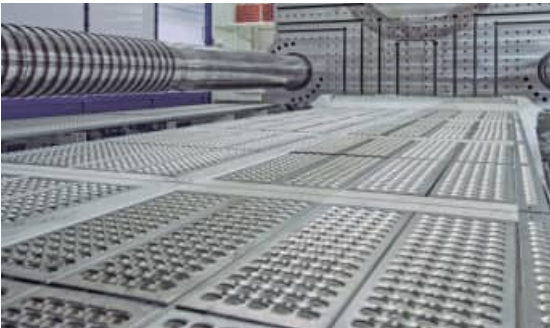
형내 안전발판을 장착하여 안전 보호 기능을 제공합니다. (900톤 이상)
